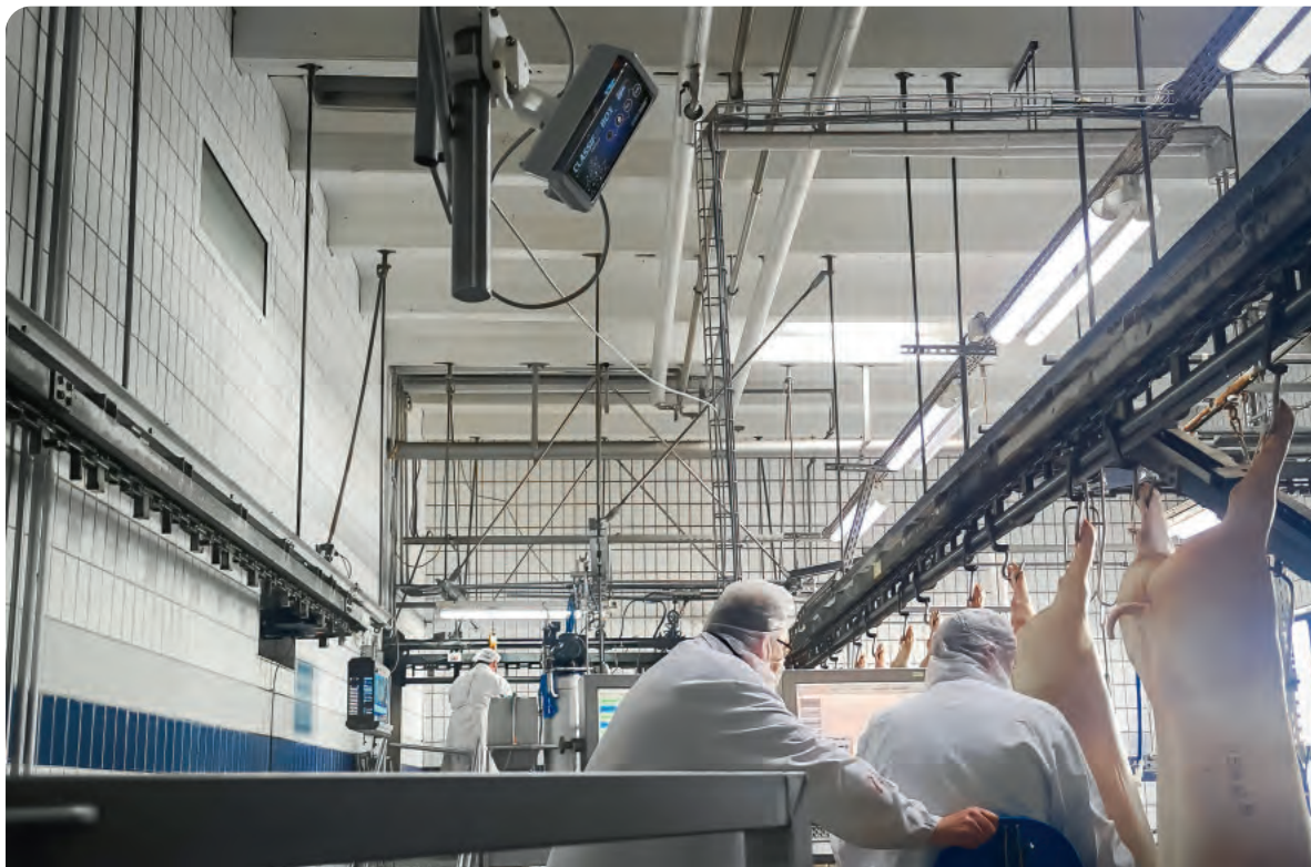
Bei der KI-unterstützten Klassifizierung assistiert die ClassifAI-Box die Mitarbeiter bei der Begutachtung der Tierwohlmerkmale an den Schweineschlachtkörpern. Foto: Foodfair
