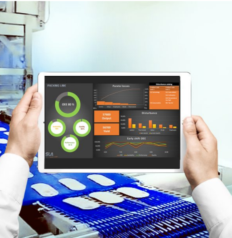
OEE schafft mehr Produktivität durch die Messung von Verfügbarkeit, Leistung und Qualität im laufenden Fertigungsprozess. Foto: SLA
