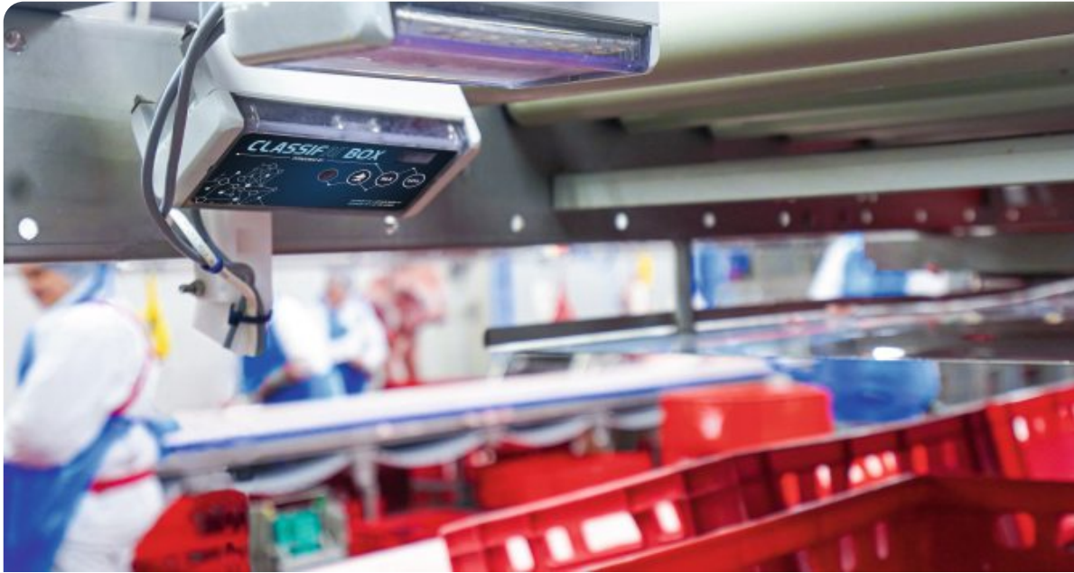
Im Zerlegeausgang im Produktionsbetrieb bei Brand Qualitätsfleisch werden mehrere hundert unterschiedliche Ausgangsartikel vom KI-System zur Identifikation des richtigen Teilstücks oder Artikels und möglicher Fremdkörper erfasst. Foto: SLA
