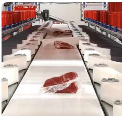
Automatisierte Artikelsortierung mithilfe bilderkennender KI. Foto SLA
