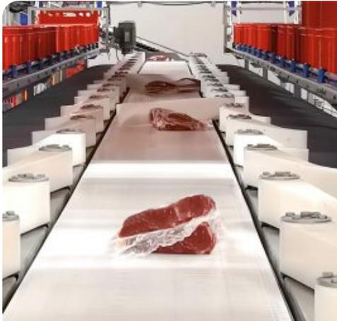
Automatisierte Artikelsortierung mithilfe bilderkennender KI. Foto SLA
